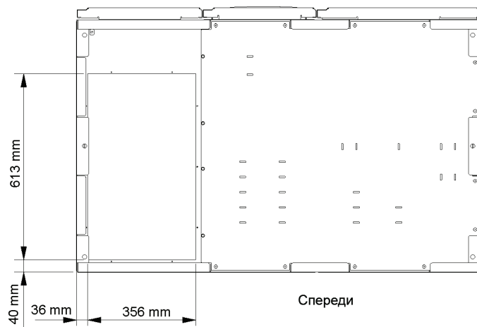
Рис. 3-4. Габариты шкафа ИБП (вид снизу)
